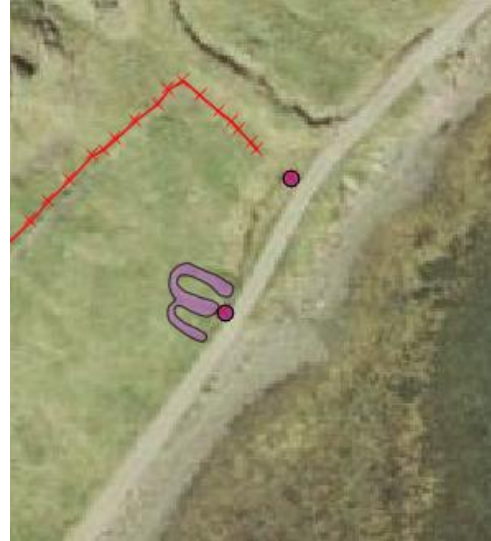
Mynd 15. Naustið er alveg við veginn og nauðsynlegt er að girða það af á meðan á framkvæmdum stendur.
