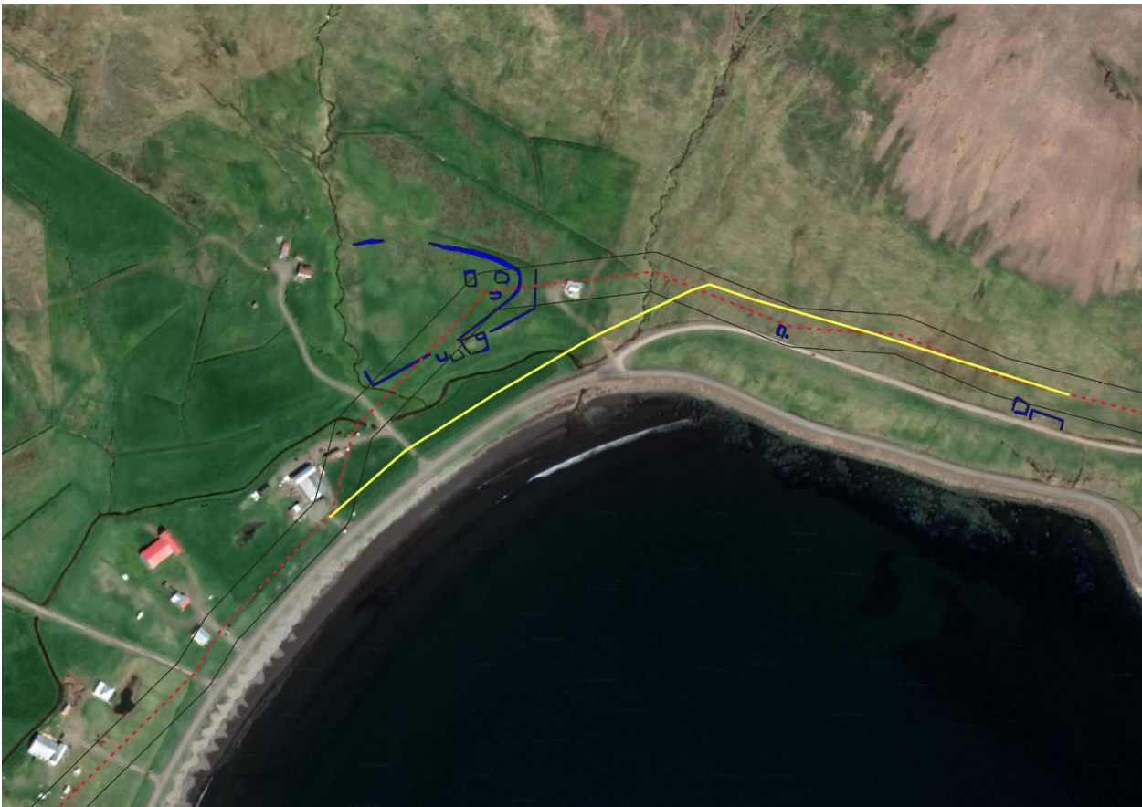
Mynd 22. Rauða punktalínan sýnir upphaflegu lagnaleið en gula sýnir þar sem ákveðið var að breyta henni til að forða henni frá minjum.
